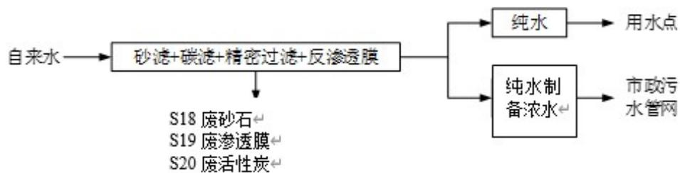
本项目设置 1 套 20L/h 能力的 RO 制纯水设备，纯水制备率为 85%，所得纯水用于清洗。项目选用的纯水系统主要采用“砂滤+碳滤+精密过滤+反渗透膜”。纯水系统会产生浓水，浓水作为清净水直接排入市政污水管网，纯水制备会产生废滤芯、废砂石、废活性炭。
