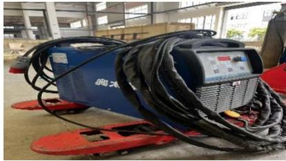
图 4-1 逆变式等离子切割机实物
